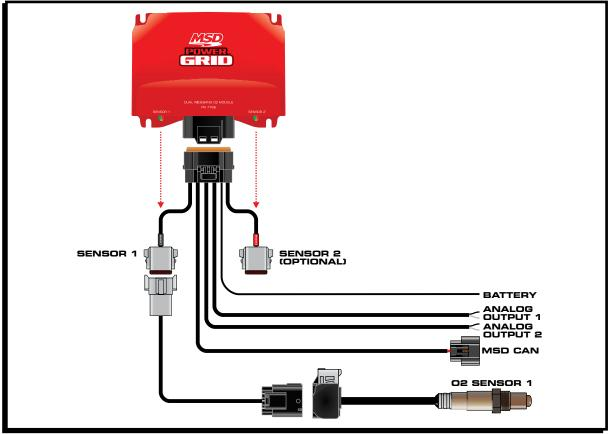
Figure1. Dual Wide Band 02 Module
