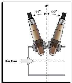
Figure4. 02 Sensor Orientation
